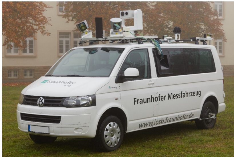
Abb. 5: Das Messfahrzeug MODISSA, mit dem die im Rahmen dieser Arbeit verwendeten Datensätze aufgenommen wurden.
