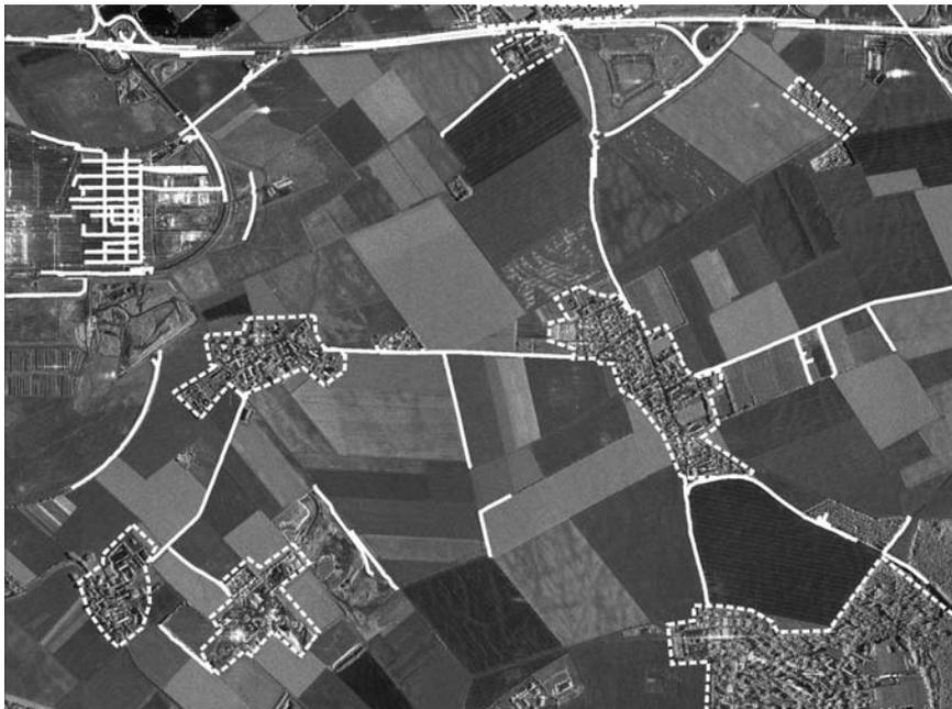
**Abbildung 4.23.** Datensatz *Stadtrand-1m*: Extraktionsergebnis mit 10 und 16 m Linienbreite
